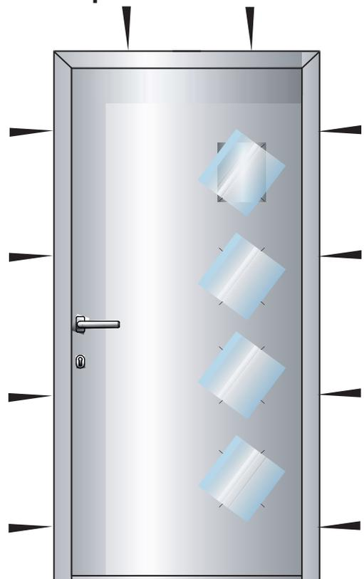
Positionnez les pattes de fixation à hauteur des paumelles et sur la traverse haute.
