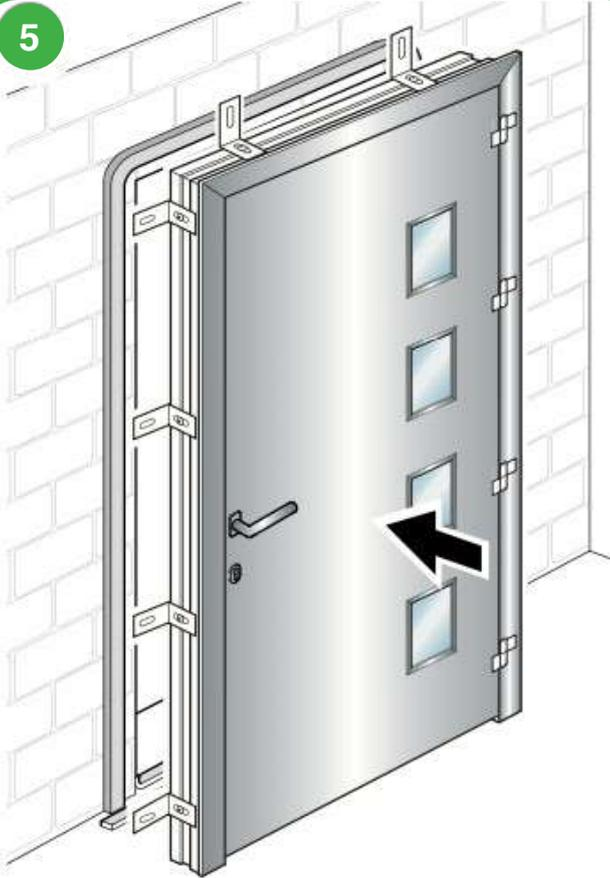
Positionnez la porte de façon à adhérer complètement sur le joint précomprimé.
