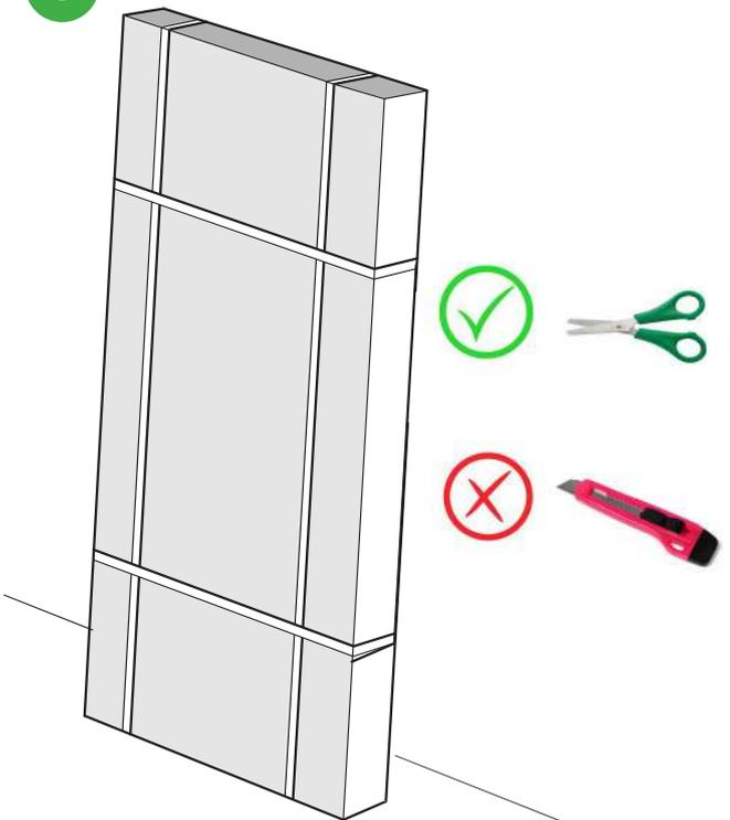
A l'aide d'une paire de ciseaux, dégagez votre bloc-porte sans endommager le produit (soulevez l'emballage avec le doigt pour ne pas rayer la porte). Pour ce faire, positionnez le bloc-porte contre un mur en vous appuyant sur les angles et bandes de renfort.
