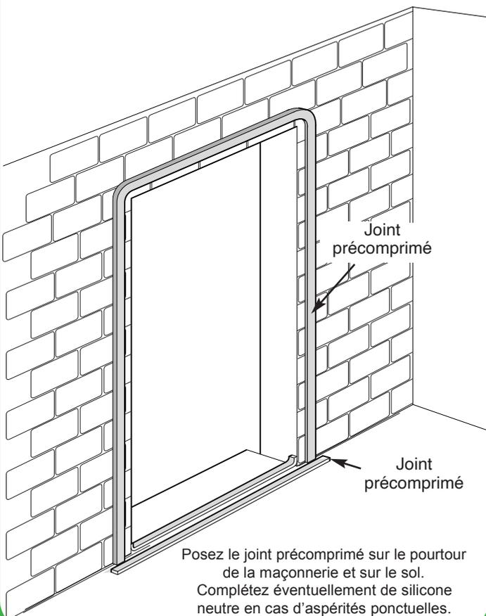
Posez le joint précomprimé sur le pourtour de la maçonnerie et sur le sol.
