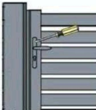
3- Mettre la poignée en place et la serrer à l'aide d'un tournevis
