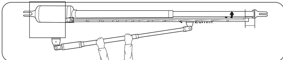
Quand les trous sont percés, désassemblez la patte de fixation portail du moteur en retirant la goupille. Fixez la patte au portail en utilisant des vis traversantes de préférence.
