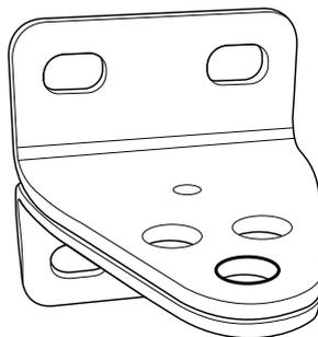
Marquer l'emplacement des trous dans le pilier en veillant à ce que la patte de fixation pilier soit montée bien horizontalement à la fin. Utiliser des tirefonds de 10 ou tout autre système de fixation adapté au matériau du pilier.
